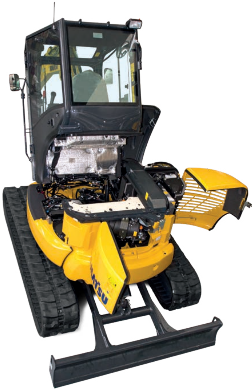
Capace de vizitare in partea din spate pentru verificari rapide ale motorului, inspectii si curatari ale radiatoarelor foarte simple si acces usor la baterie
